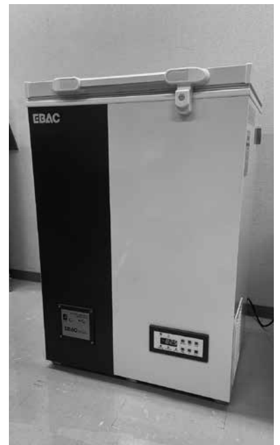
▲-80℃でファイザー社製のワクチンを保管するディープフリーザー
