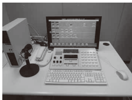
▲新たに導入した「親局設備」。屋外拡声子局に対し、防災情報や行政情報などの放送を行います。
